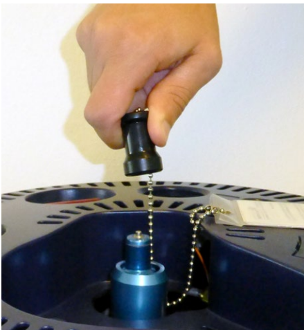
1. Entfernen Sie die Schutzkappe vom Füllstutzen.
