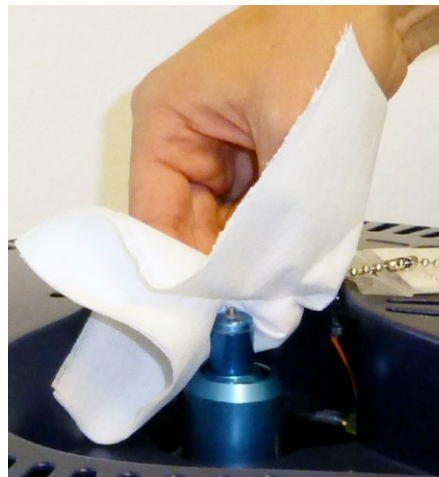
2. Wischen Sie den Füllstutzen trocken.
