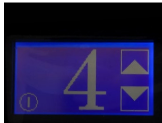
Einstellknopf (Nummerierung der Stufe entspricht nicht der Sauerstoffmenge in l/Min.)
